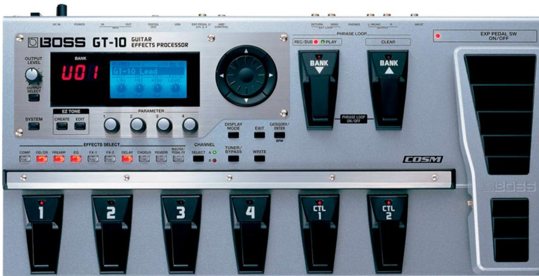
Ein Multieffektprozessor beinhaltet verschiedenste digital simulierte Effektgeräte in einem, welche sich beliebig in Reihe koppeln lassen. Ein solches Floorboard ist neben den über diverse Regler veränderbaren Grundeinstellungen durch Fußschalter und ein Pedal auch beim Spielen der Elody steuerbar.
